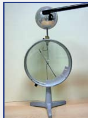
Elektriziranje elektroskopa negativno
