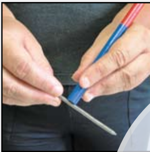
Magnetizacija željeznog čavla
